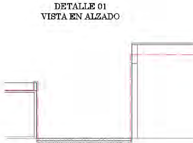
Tubería de gas de 1 1/2 mm diámetro envevida en ducto de concreto de 200 kg/m2.
