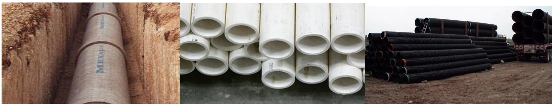
Imagen. 32 tuberías de Asbesto Cemento, PVC y Fierro Fundido.
