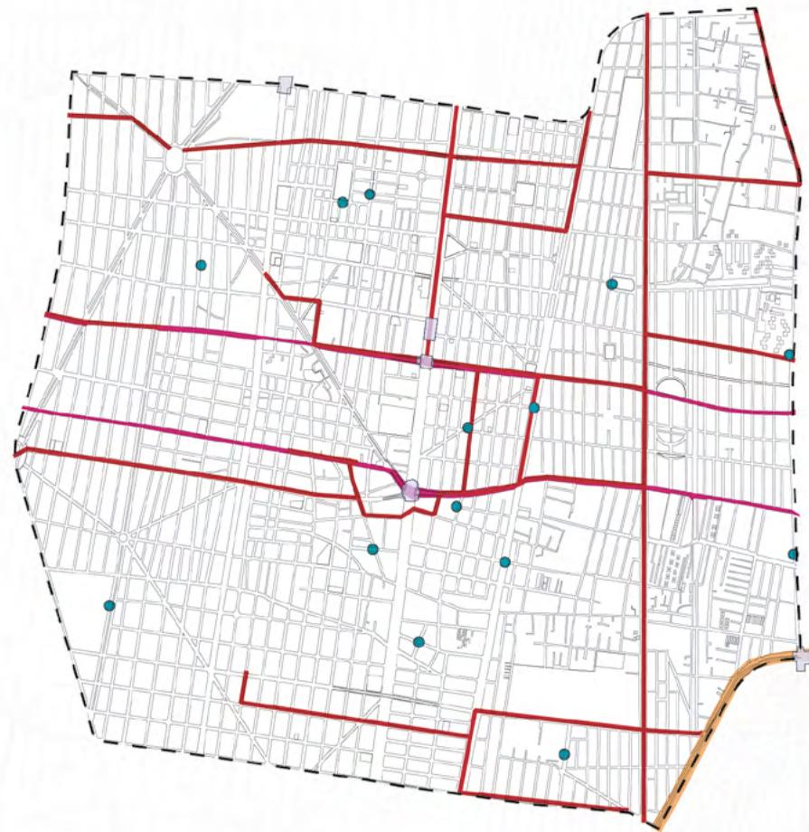
Al interior del polígono de estudio, se puede observar que la red de interceptores de drenaje, que se encuentran principalmente debajo de grandes avenidas y que antiguamente eran canales como Calzada de la Viga, Plutarco Elías Calles que forma parte del Gran Canal de Desagüe y Calzada de Tlalpan que era el antiguo dique de Tenochtitlán.
