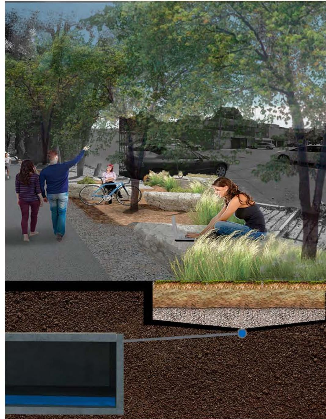
**(2017). SECCIÓN ANDADOR PEATONAL CON BIO-RETENCIÓN CON POSIBILIDAD DE ALMACENAJE DE AGUA PLUVIAL. FIG. 6.33.**
