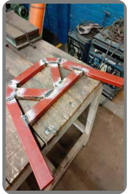
Imagen 45 Detalle de la base soldada.
