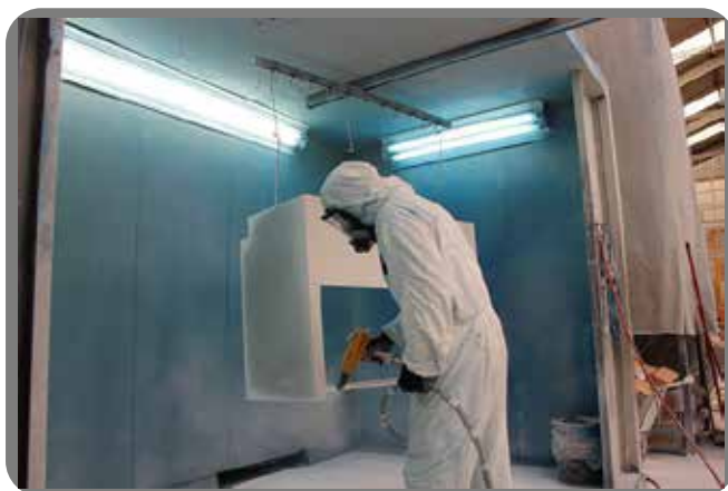
Imagen 49 Aplicación de pintura electrostática.
