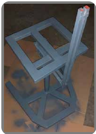
Imagen 48 Estructura con pintura primaria.
