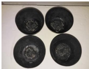
Figura 23. Calcinación de muestras en mufla.
