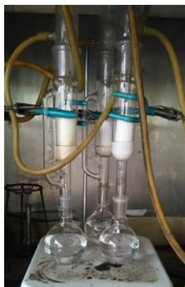
Figura 21. Extracción de grasa por Soxhlet.
