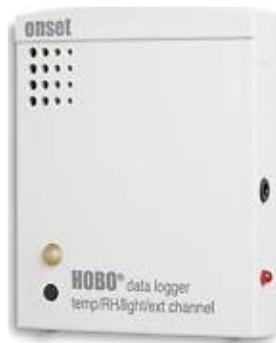
Imagen 5. HOBO datalogger Imagen tomada por el autor
