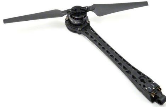
FIGURA 4.2: Sistema de propulsión (elemento) del MUAV S800-EVO.
