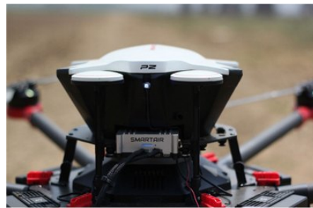
FIGURA 5.6: Paracaídas SafeAir MATRICE 600.
