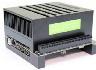
FIGURA 5.14: Sistema embebido Jetson Xavier.
