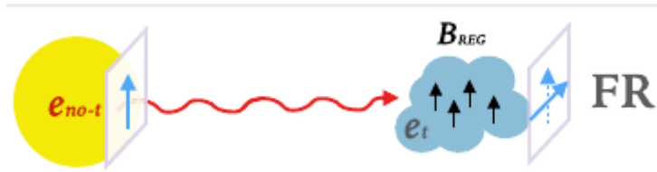
Figura 1.9: Esquema de rotación Faraday. La zona amarilla representa la emisión no térmica, la zona azul representa una nube magnetoionica de electrones térmicos con campos magnéticos regulares. Créditos: (Pasetto et al., 2018)
