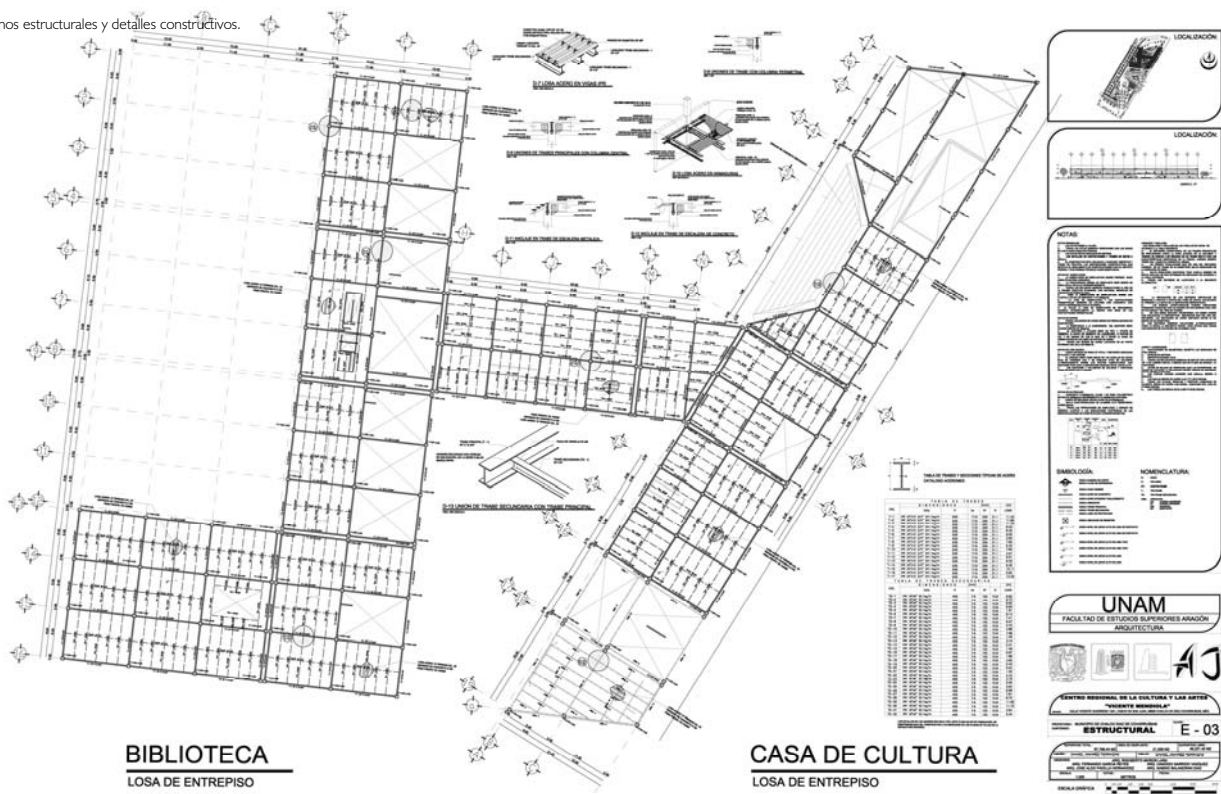
Imagen 179. PLANO ESTRUCTURAL – LOSA DE ENTREPISO BIBLIOTECA Y CASA DE CULTURA – E-03 . Fuente: Elaboración propia.
