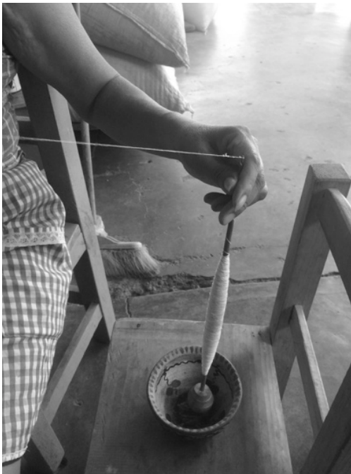
Imagen 10. Proceso de re-hilado en petet de hilo de algodón comercial (hilera) de dos cabos. (foto de la autora)
