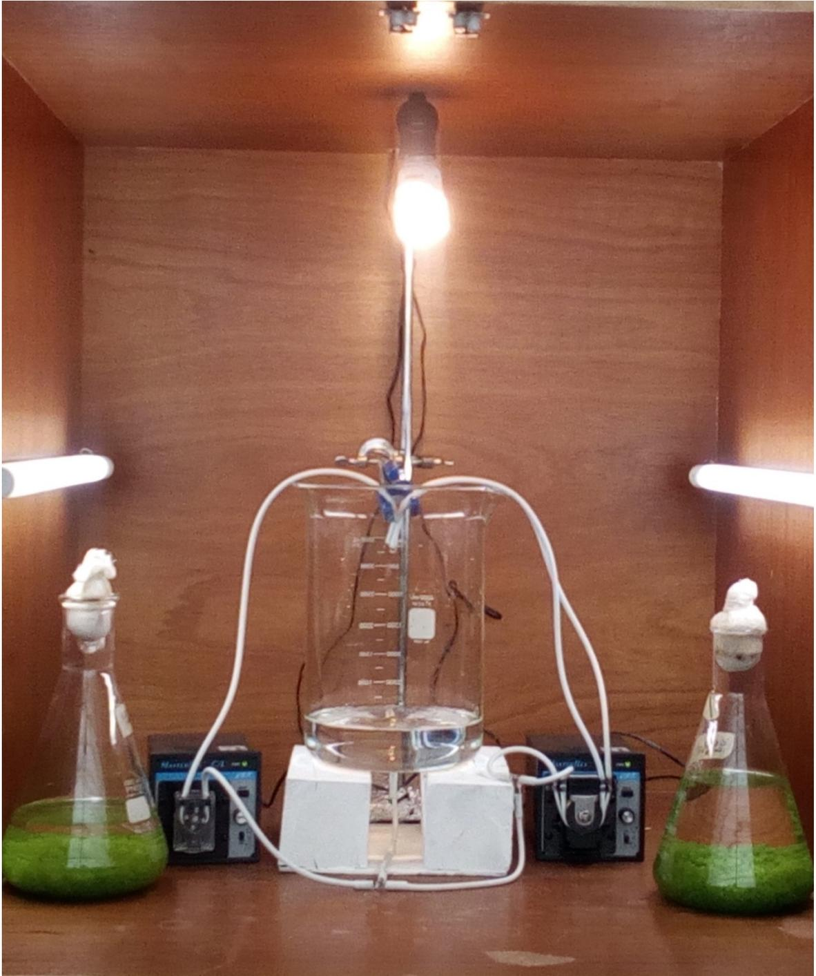
**Figura 3.9** Montaje del reactor RSI4000. Vaso de precipitado con salida interior sobre base de madera conectado a dos bombas peristálticas MasterFlex mediante una tubería Viton blanca y una conexión “T” de vidrio, Ensayo expuesto a luz amarilla mediante un foco de 10 watts. En la misma fotografía se aprecian las microalgas inmobilizadas *Scenedesmus acutus* (lado derecho) y *Selenastrum capricornutum* (lado izquierdo)
