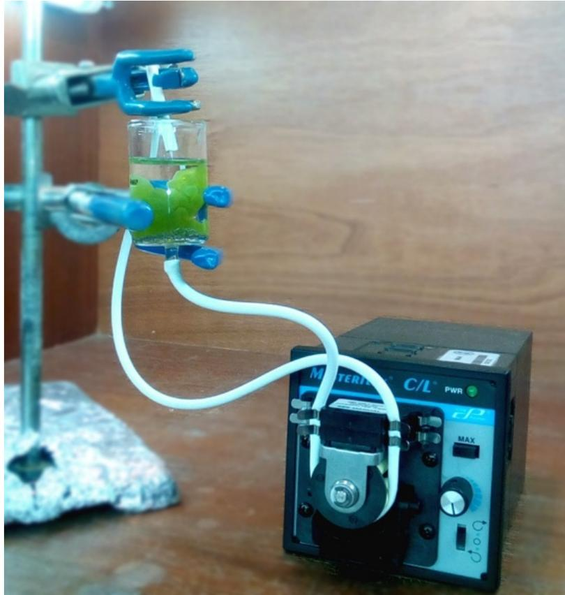
**Figura 3.7** Reactor tipo tanque con salida inferior RSI50, Reactor de vidrio con salida inferior conectado a una bomba peristaltica mediante una manguera de Viton blanco
