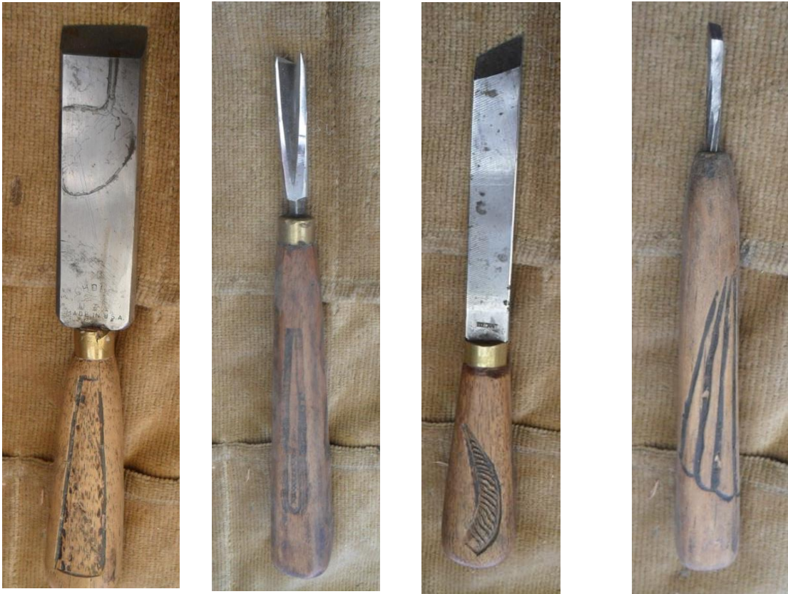
a b c d Fig. 2. 12 Cuatro tipo de gurbias de la talla en madera. a) Formón; b) Uñeta; c) “Pata de cabra”; d) “Espinita”. Fotos: David Medina Pérez.
