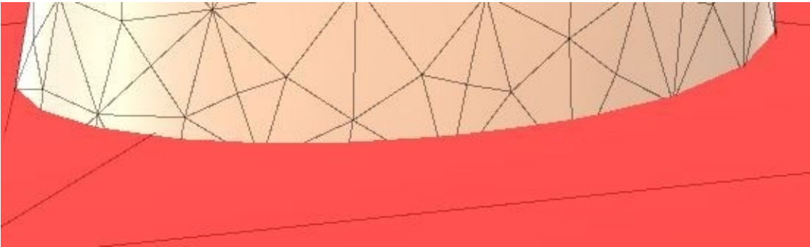
Figura 5.5-3 Detección de triangulación atravesada por Plano transversal
