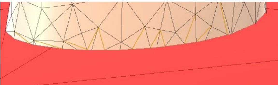
Figura 5.5-4 Retriangulación de malla atravesada por plano
