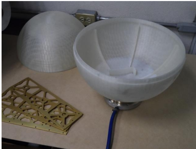
Fig. 4.6. Piezas de la esfera fabricadas mediante manufactura aditiva para lograr la precisión adecuada, después de pulirlas.
