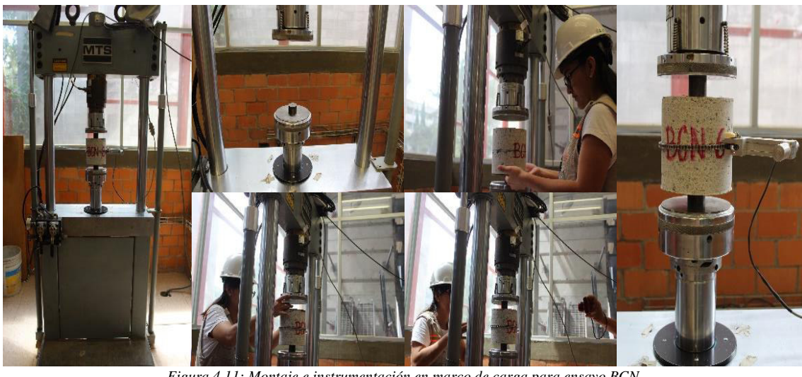
Figura 4.11: Montaje e instrumentación en marco de carga para ensayo BCN
