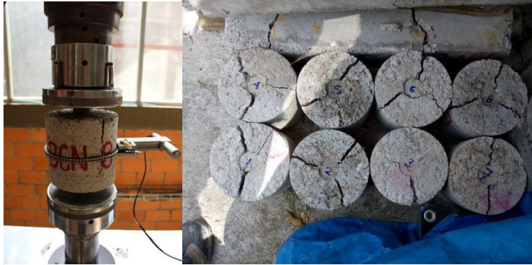
Figura 4.12: Ensayo de espécimen y modo de falla de los cilindros ensayados, BCN.
