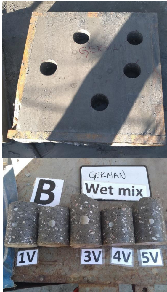
Figura 2.6: Corazones extraídos a partir de panel cuadrado.
