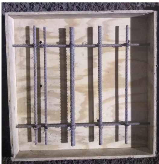
Figura 2.5: Molde de Panel cuadrado con varillas de refuerzo para prueba de habilidad de lanzador.
