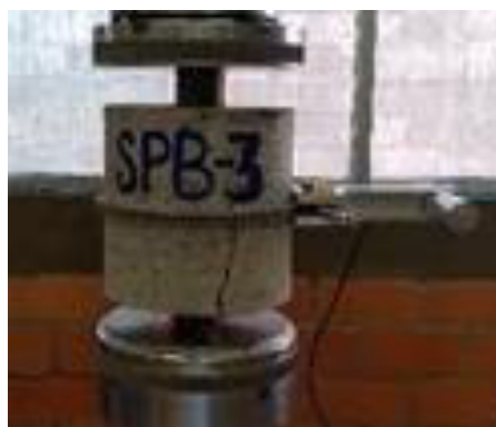
Figura 10 - Ensayo de doble punzonamiento, configuración, UNE 83515
