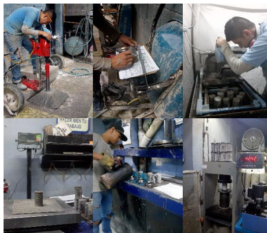
Figura 3.10: Proceso de ensaye de cilindros (NMX-C-083-ONNCCE).
