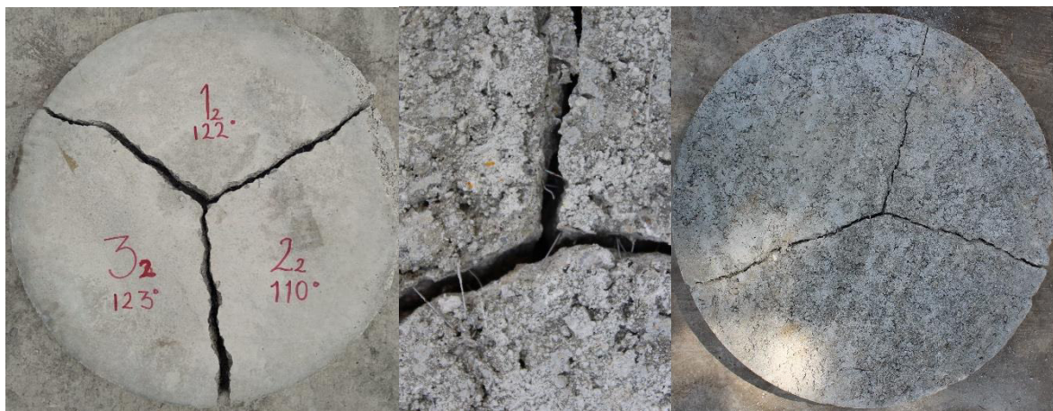
Figura 4.22: Entrelazado de fibras en zona de falla de paneles circulares. Etapa 3
