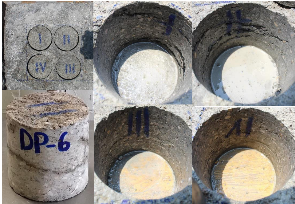
Figura 4.29: Irregularidades presentes en probetas extraídas a partir de la artesa 2. Etapa 2
