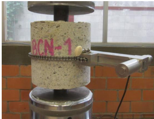
Figura 8 - Ensayo de doble punzonamiento, configuración, EN 83515
