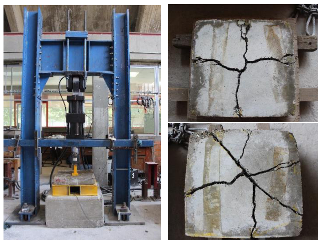
Figura 4.6: Ensayo y modo de falla de paneles cuadrados.
