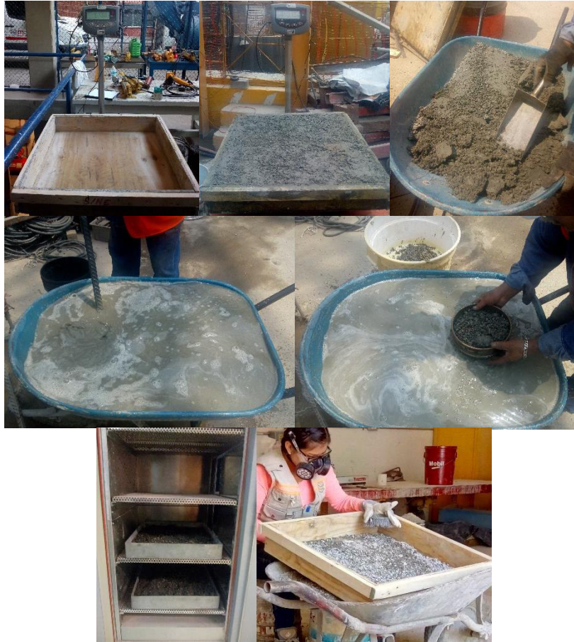
Figura 4.13: Procedimiento para el conteo de fibras en estado fresco.
