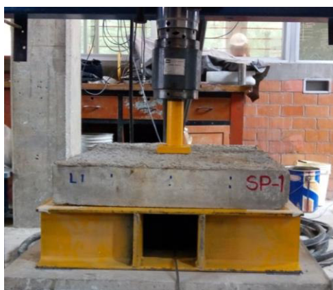
Figura 3 - Ensayo de panel de sección cuadrada, EN 14488-5
