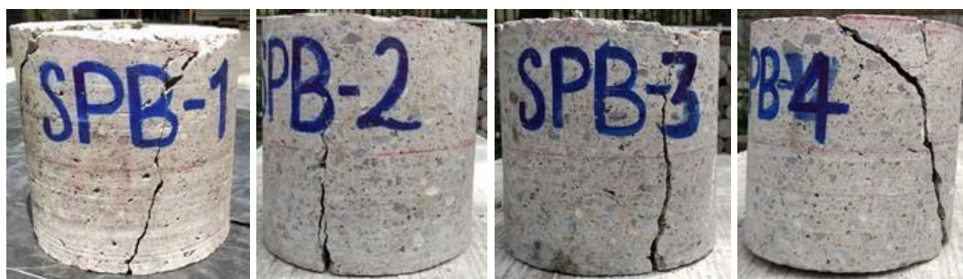
Figura 9 - Modo de falla típico de los cilindros, Ensayo Barcelona.
