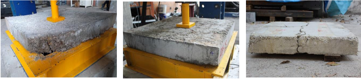
Figura 4.7: Desprendimientos de material en paneles cuadrados.
