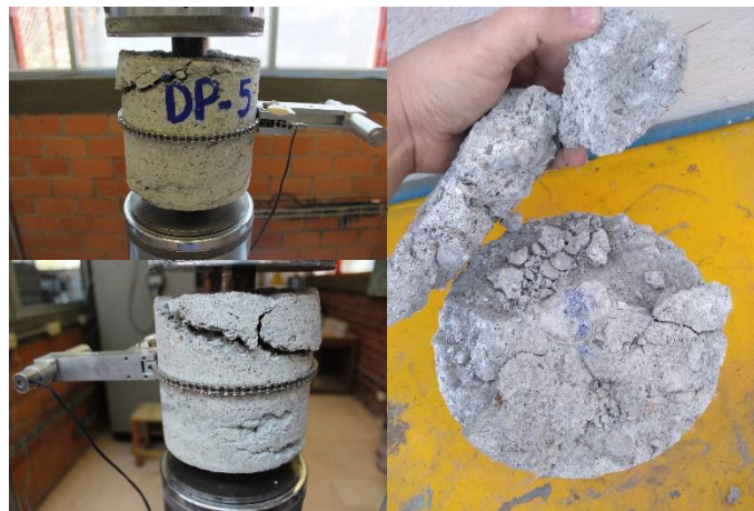
Figura 4.30: Modo de falla de cilindro DP-5, artesa 2. Etapa 2
