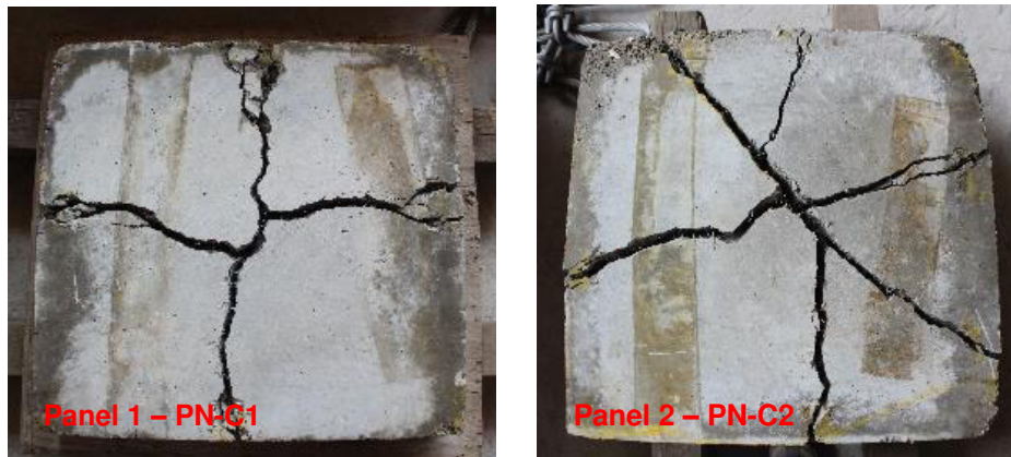
Figura 4 - Modo de falla típico de los paneles cuadrados ensayados
