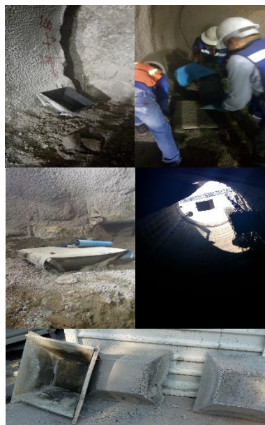
Figura 3.9: Proceso de muestreo de artesas.
