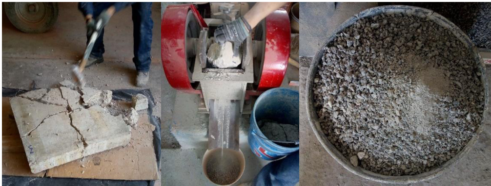
Figura 4.14: Proceso de demolición y trituración de espécimen.
