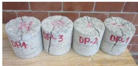
Figura 9 - Modo de falla típico de los cilindros, Ensayo Barcelona.
