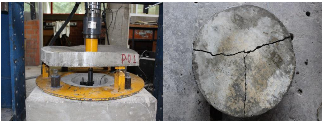
Figura 4.9: Comportamiento de panel circular durante aplicación de carga y fisura post- ensayo.
