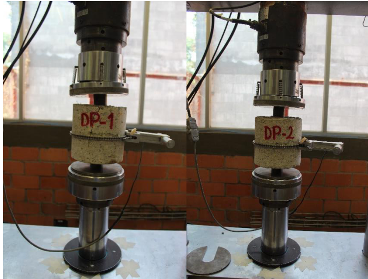
Figura 4.26: Comportamiento de cilindros DP-1 y DP-2 durante ensayo (rótula desalineada).
