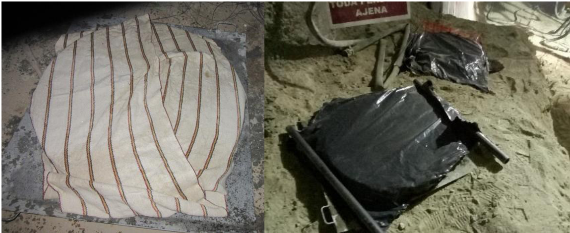
Figura 4.3: Protección de muestras dentro del túnel.
