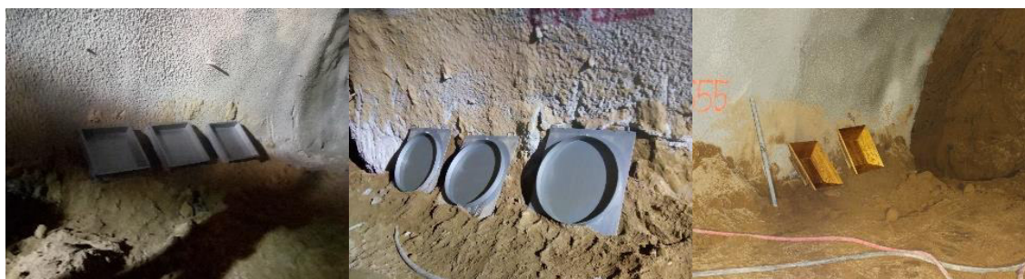
Figura 4.1: Colocación de moldes en posición para muestreo.
