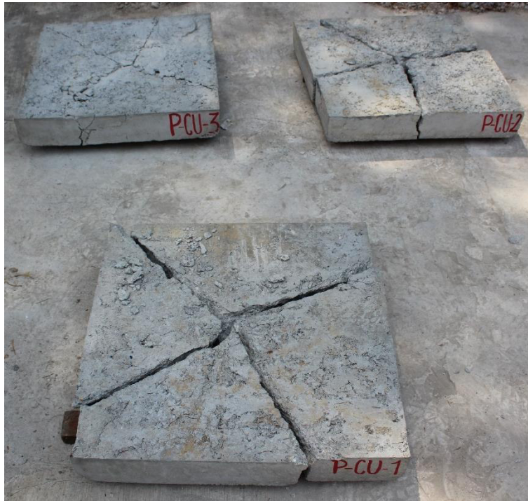
Figura 4.17: Modo de falla de paneles cuadrados correspondientes a la etapa 2.
