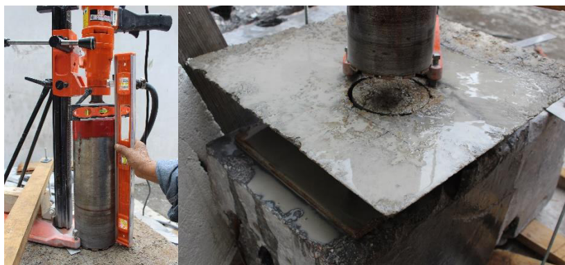
Figura 4.10: Extracción de cilindros para ensayo BCN
