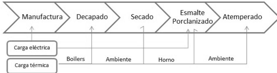
Imagen 1. 1 Proceso de conformado de la carga y tipo de energía asociada
