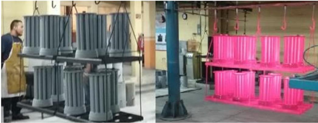
*Imagen 2. 6 Carga previo al proceso de horneado y carga después del tratamiento térmico*
