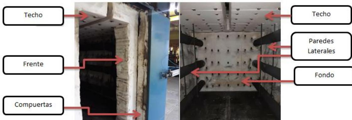
**Imagen 2. 5 Superficies recubiertas de aislante**
