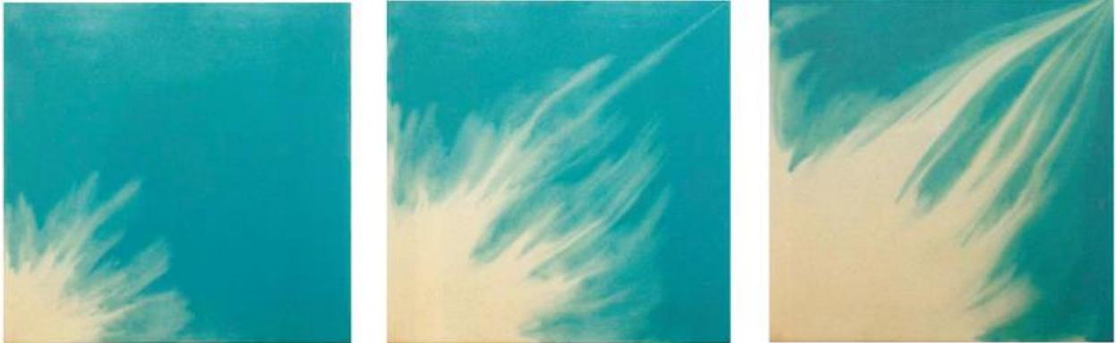
**Figura III.18 Frente de desplazamiento para un proceso miscible con una relación de movilidad desfavorable.** <sup>52</sup>
