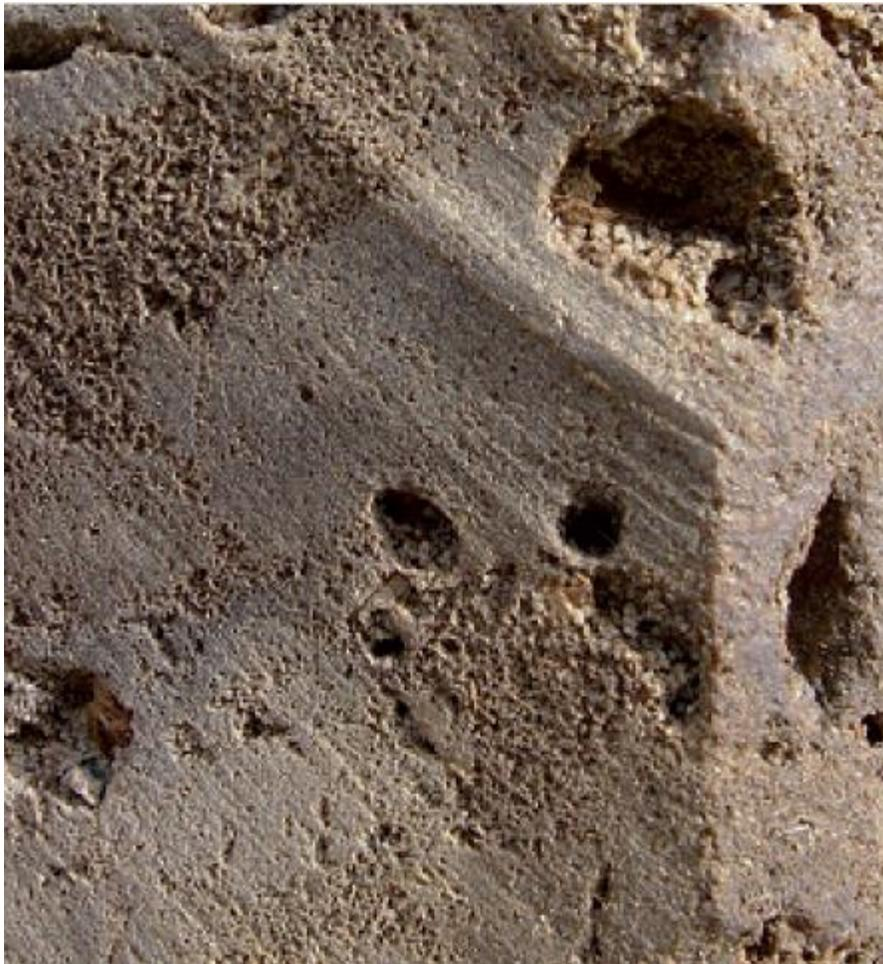
**Figura III.19** Porosidad compleja en rocas carbonatadas.
