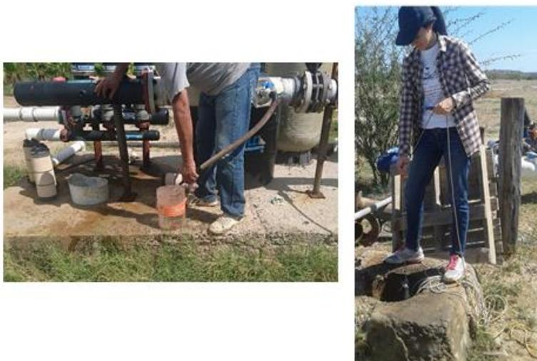
**Figura 8.2** Toma de muestras de aguas subterráneas por medio de bomba y muestreador Bailer
