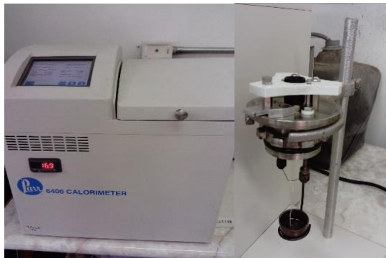
Figura 19. Calorímetro Parr 6400 utilizado en la medición de calor de combustión.
