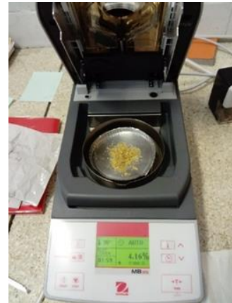
Figura 12. Termobalanza utilizada para determinar la humedad de las semillas de limón
