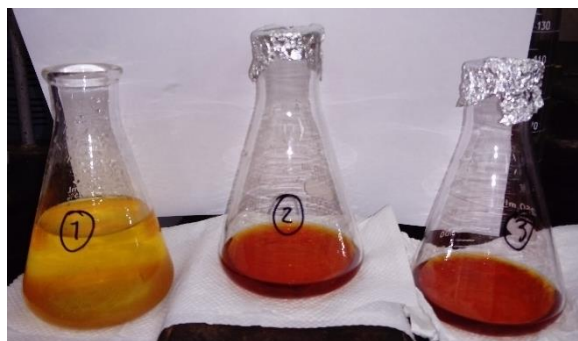
Figura 20. Aspecto final de la valoración con sol. de \text{Na}_2\text{S}_2\text{O}_3 hasta amarillo pálido.
