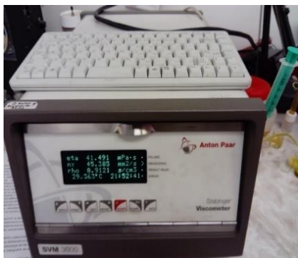
Figura 18. Viscosímetro Stabinger empleado para la determinación de la densidad y viscosidad.
