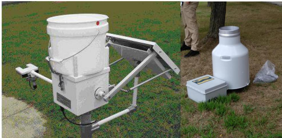
Figura 35. Equipos de muestreo: Colector de cubeta N-CON y pluviómetro Hatch Pluvio, respectivamente.
