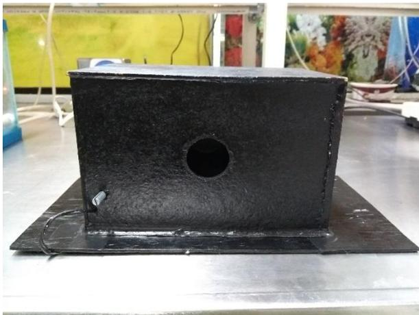
centro y dentro de esta, se colocó una pecera pequeña para posicionar al pez y fotografiarlo. La cámara se encontró a la distancia de 16 cm y mediante un agujero de 3.5 cm de diámetro, se tomaron las fotografías.
