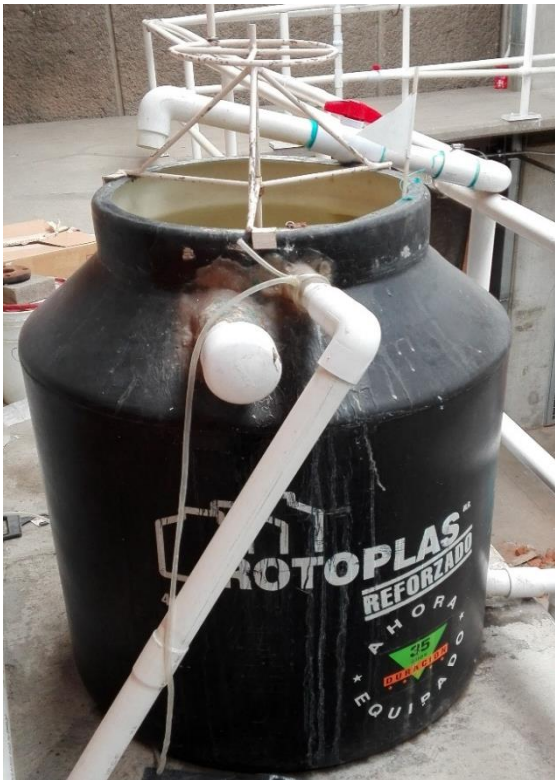
Figura 16. Tanque de almacenamiento de los dispositivos y mezclador manual.
