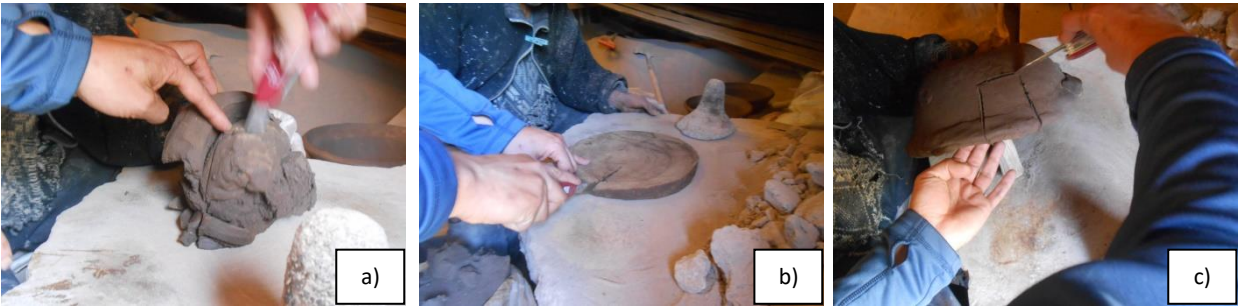
Figura 5.2. Ejemplos de las muestras de las etapas en la elaboración de la vasija. a) Barro amasado con material sobrante y nuevo agregado, b) Primeros golpes del macetón, c) Colocación de un “parche” en el borde.
