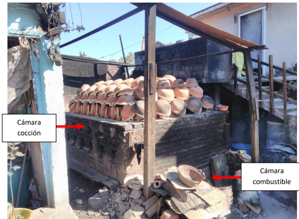
Figura 6.3. Horno de quema con sus diferentes partes señaladas.
