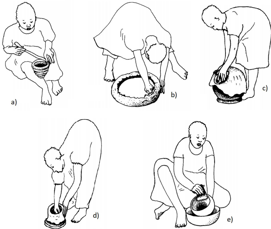
Figura 3.1. Técnicas de elaboración de vasijas: a) enrollado, b) modelado, c) moldeado d) falso torno, e) paleado y yunque (Tomado y modificado de Gosselain, 2000:201).
