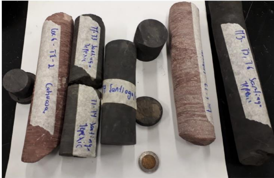
Figura 9.6. Muestras seleccionadas para pruebas de porosidad y permeabilidad en laboratorio.
