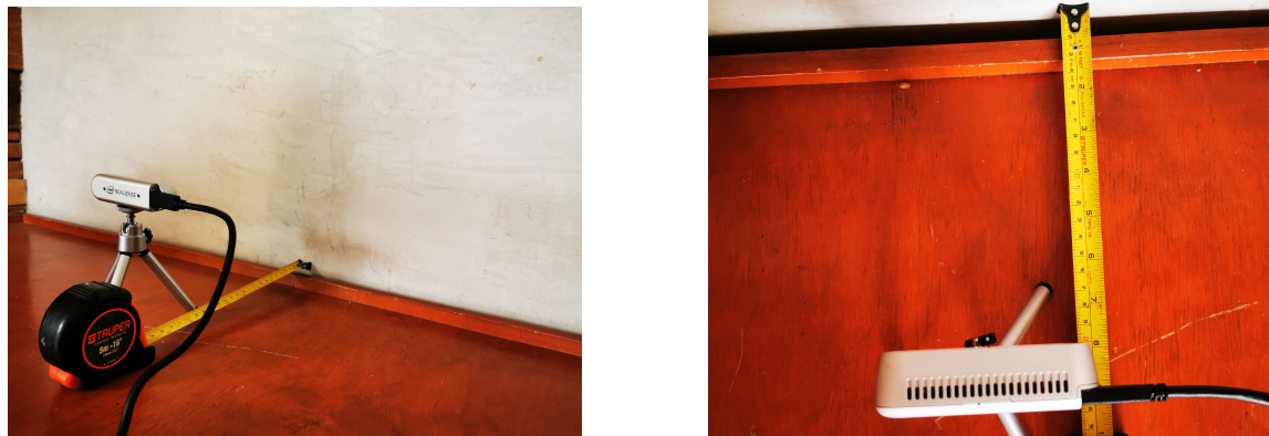
Figura 3.5: Obtención de registros de profundidad a distintas distancias.
