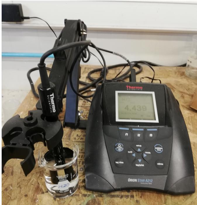
Figura B.1: Experimento para la medición de conductividades.
