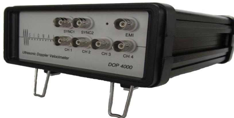
Figura 4.5: Panel frontal del velocímetro DOP4000. Imagen tomada de [Signal Processing S. A. \(2019\)](#).
