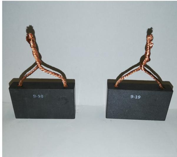
Figura 4.3: Electrodos de grafito utilizados para la fabricación de la bomba.
