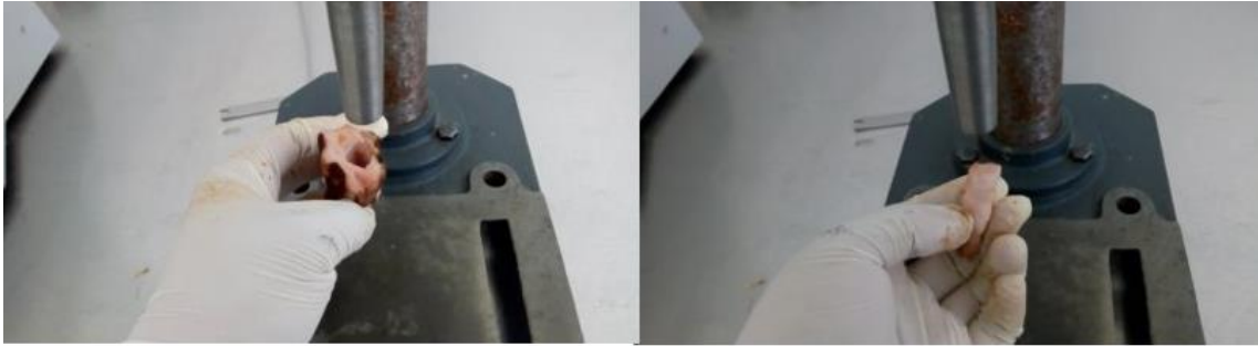
Figura 6, Obtención de cilindros para la medición de fuerza de corte. (Silva, 2019)
