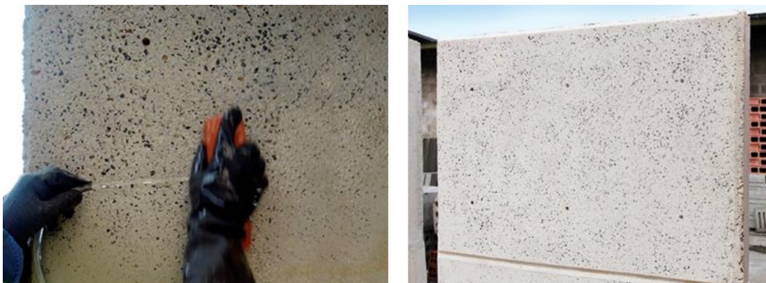
Figura 9. Superficie tratada con ácido muriático.
