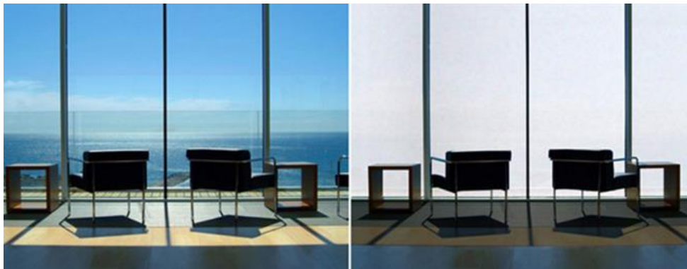
Figura 28. Cristales termocrómicos. Películas delgadas de dióxido de vanadio
