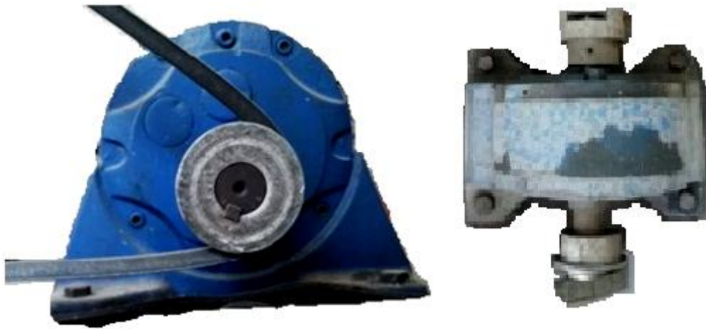
Figura 4.4.5.1 Reductor de velocidad vista frontal y de planta respectivamente.
