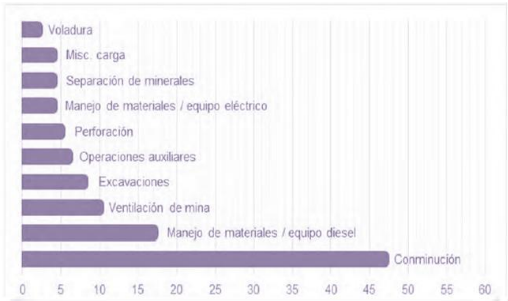
Figura 1.5.1.5 Repartición de energía requerida en el proceso industrial de procesamiento de minerales (Alzate, 2016).
