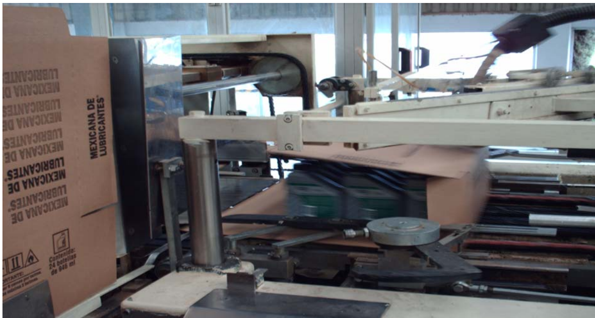
Fig. 8, máquina para el empacado de la presentación de 24 botellas en una caja.
