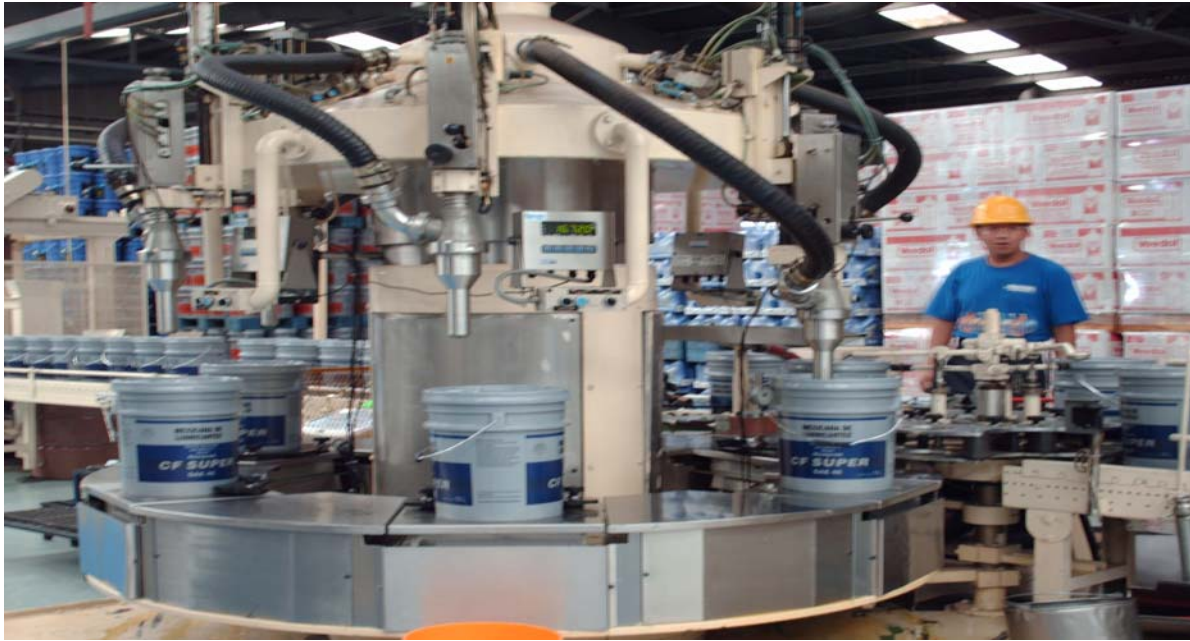
Fig.12, carrusel de llenado con 6 disparos para el envasado de cubeta. El operador regula la velocidad de la máquina.
