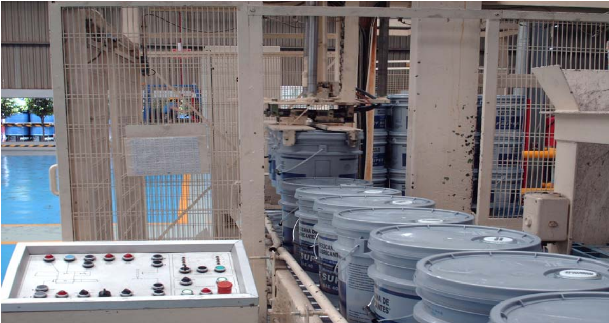
Fig.14, alineación de cubetas en transportador de entrada a máquina paletizadora.
