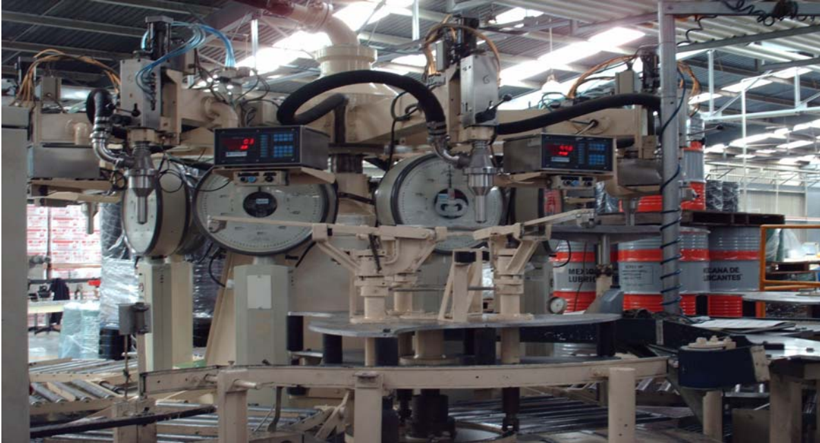
Fig.17, llenadora semiautomática para tambor de 208 L con carrusel de 8 disparos.
