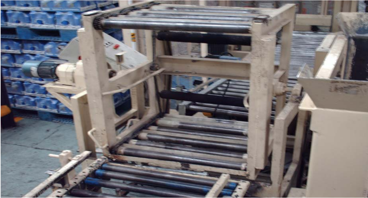
Fig.18, volteador de tambor y entrada a máquina paletizadora.
