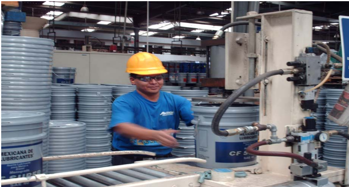
Fig. 11, el operador coloca la cubeta en la colocadora de tapas para unir ambas piezas.
