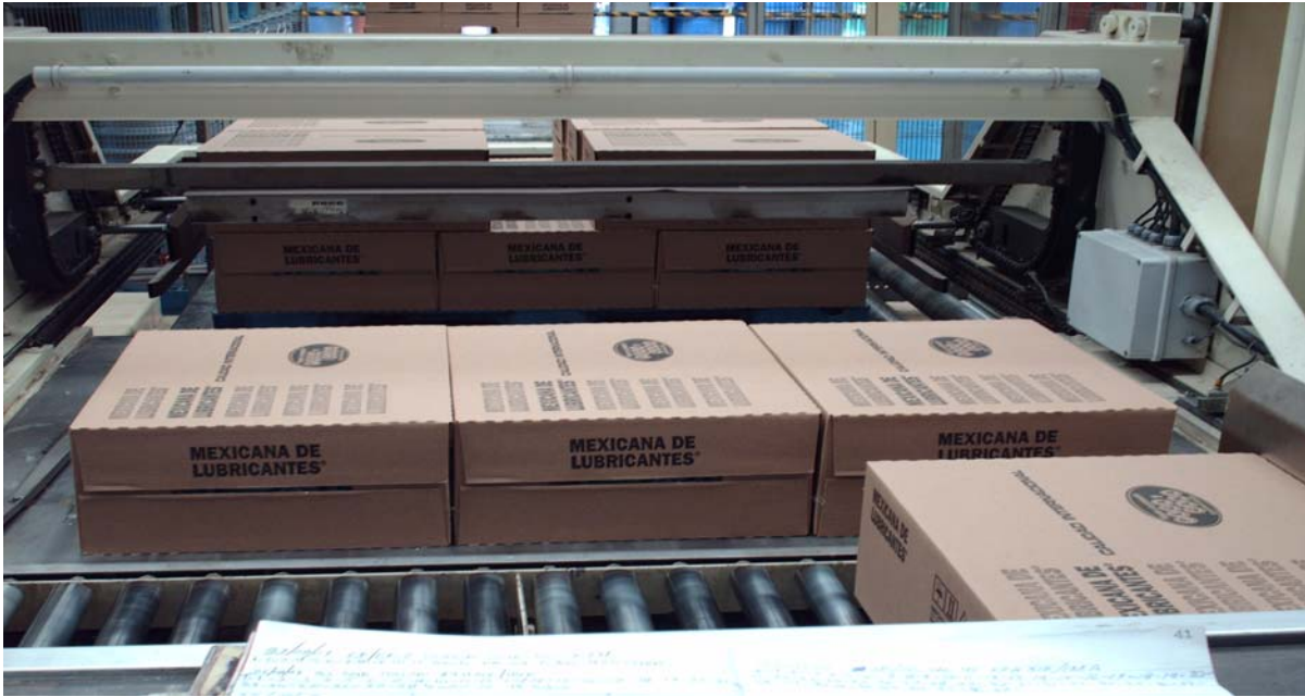
Fig. 9, alineación de cajas en estibas de 6 cajas para la formación de tarima
