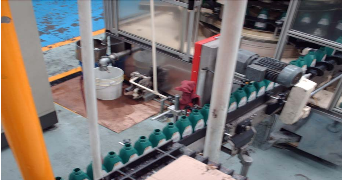
Fig. 5, transportador de entrada o alimentación a máquina dosificadora de botella de 1L tipo revolver.
