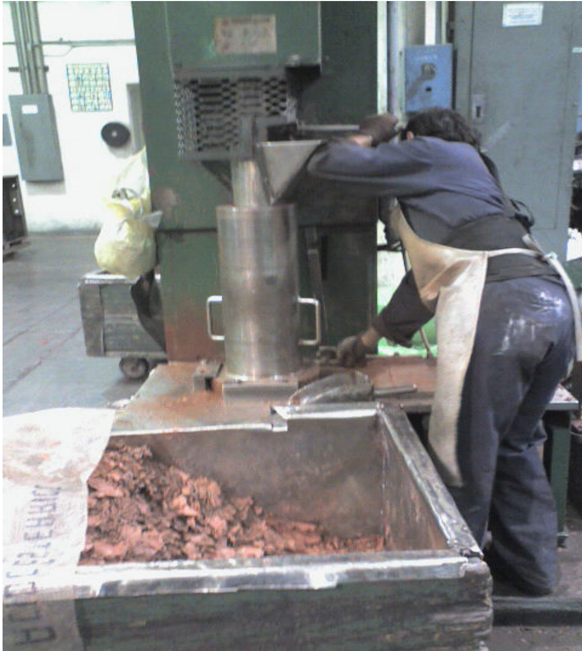
Figura 3.6 Compactado de la pasta en martillo vertical para puntilla de color.
