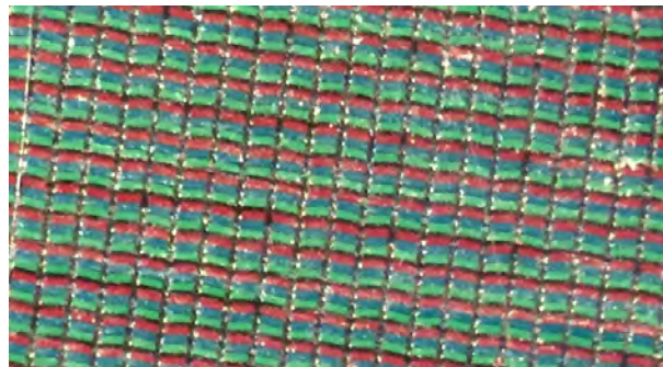
Figura 5.1: Filtro de color de la tecnología ICT TFT-LCD observado en un microscopio Motic DMWB3.
