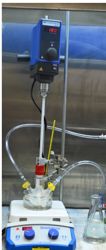
Figura 2-3: Dispositivo experimental para las reacciones de policondensación.
