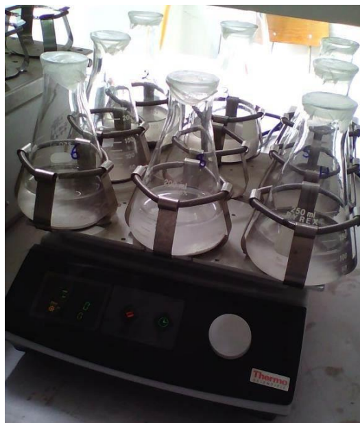
Figura 3.5. Pruebas batch por medio de un agitador orbital.
