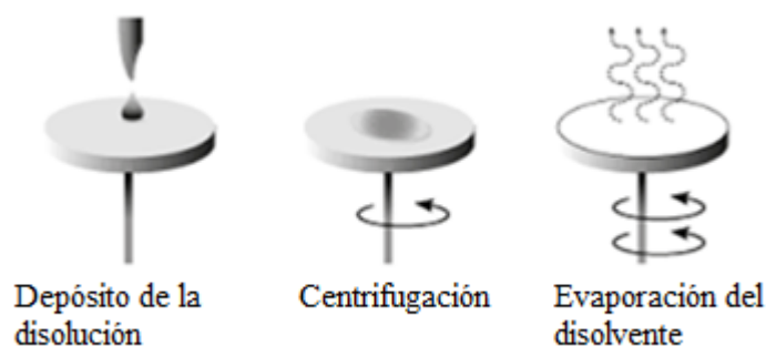
Figura 2.18. Esquema del proceso de recubrimiento por centrifugado ( spin coating ).
