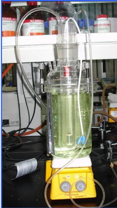
**Figura D.1** Reactor fotoquímico.
