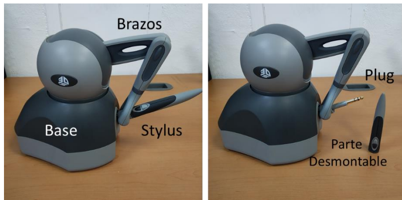
Ilustración 20. Segmentos de los que consta el dispositivo háptico Phantom Touch y su parte desmontable.
