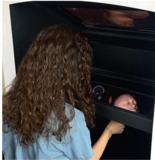
Ilustración 8. Configuración del Immersive Touch, el modelo virtual es visto a través de un espejo (Brunozzi et al., 2018).
