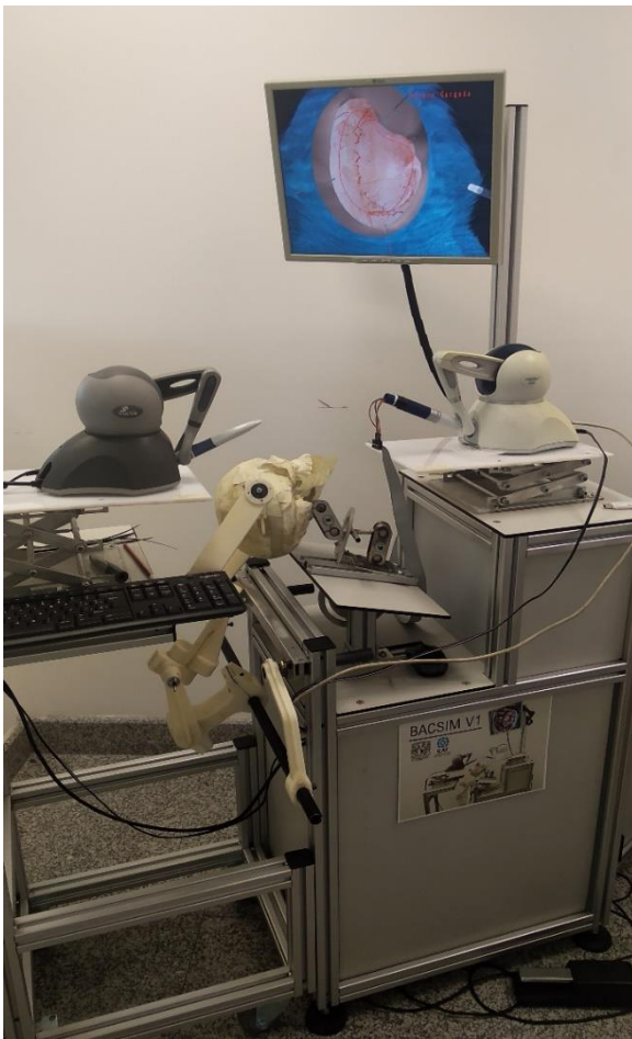
Ilustración 25. Estación de trabajo en donde se instaló el simulador en el Hospital General Eduardo Liceaga. El dispositivo háptico de la derecha es en el cual se instaló el craneótomo 3D. El cráneo que se muestra no tiene relevancia en la simulación (parte de otros proyectos)
