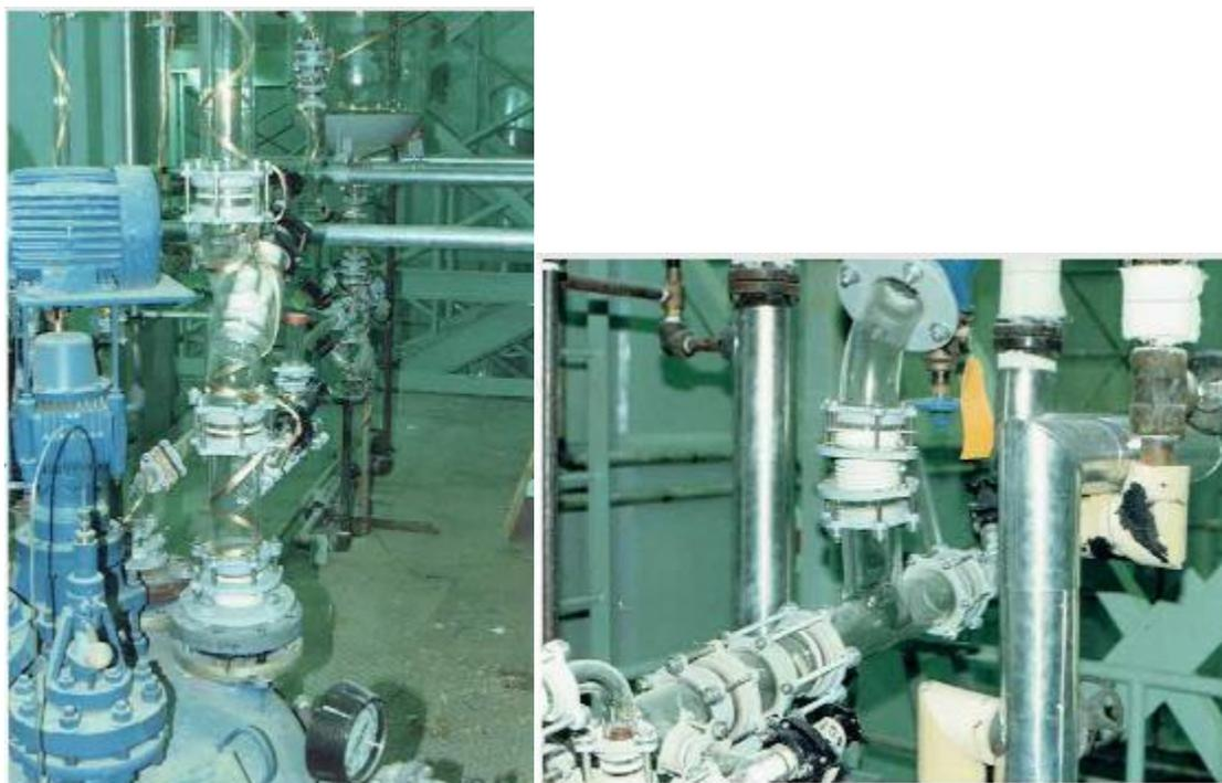
*Figura 3.5. Tubos de vidrio para fabricación de propranolol.*
