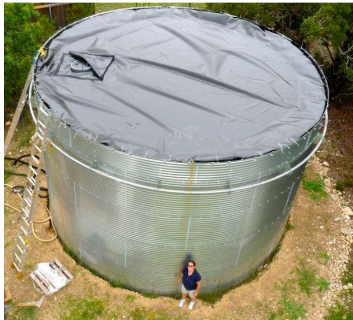
Fig. 3 Prototipo final de un tanque Cherenkov desarrollado por la Colaboración HAWC a tamaño real.
