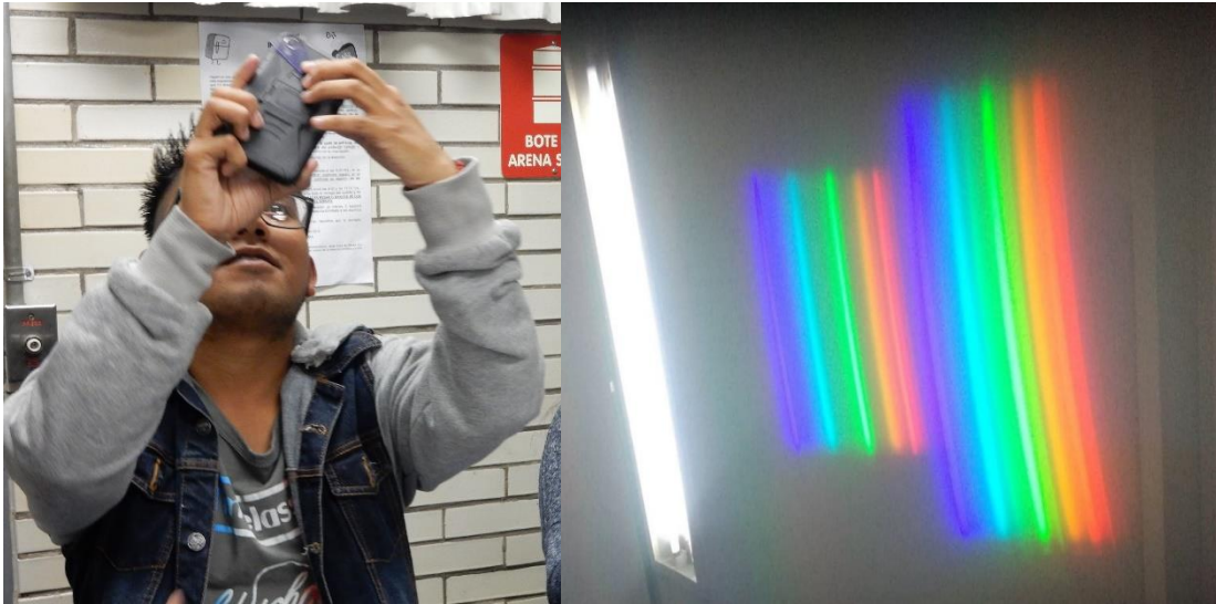
Imagen 24: Espectro de la lámpara del laboratorio usando el espectroscopio de celular.
