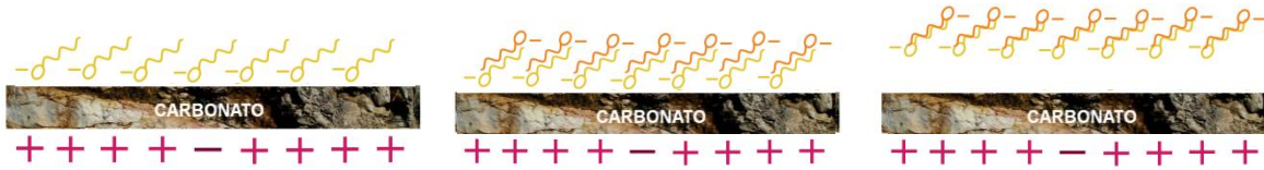
Figura 12 Simulación del funcionamiento de los surfactantes aniónicos y no iónicos. a) Las moléculas representan los ác. nafténicos del crudo que se adsorben a la roca. b) Interacción de surfactantes aniónicos y no iónicos con los ácidos. c) Interacción hidrofóbica.
