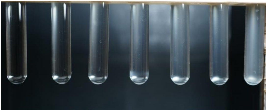
Figura 22 Soluciones de surfactantes no compatibles variando salinidad y temperatura (22°C y 92°C respectivamente). Salinidad de izquierda a derecha: Agua Tipo I, 20,000ppm, 40,000ppm, 60,000ppm, 80,000ppm, 100,000ppm y agua de inyección M199.
