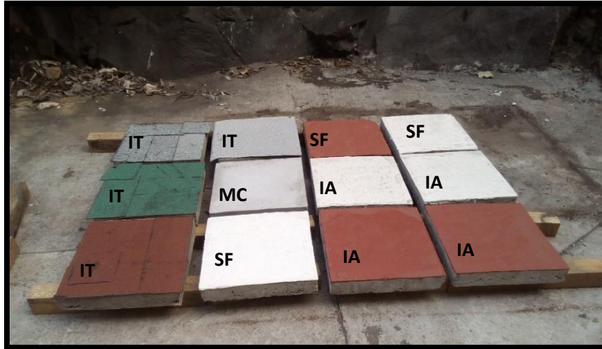
Figura 7. Disposición de las muestras en el patio del Laboratorio de Edificaciones Sostenibles, Facultad de Arquitectura, UNAM. Tipos de materiales: Impermeabilizante tipo teja (IT), impermeabilizante acrílico (IA), superficie fresca (SF), muestra de concreto (MC).
