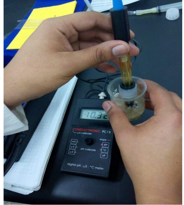
Figuras 21 (a) y (b) Foto de la metodología empleada para la medición del PH de la muestra de suelo problema.
