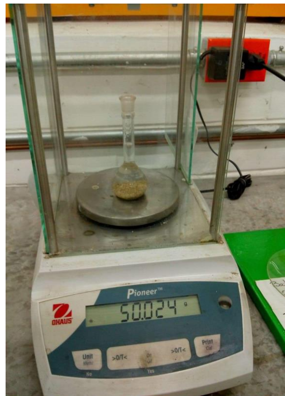
Figuras 23 (a) y (b) medición de la masa de suelo para el cálculo de la densidad real.
