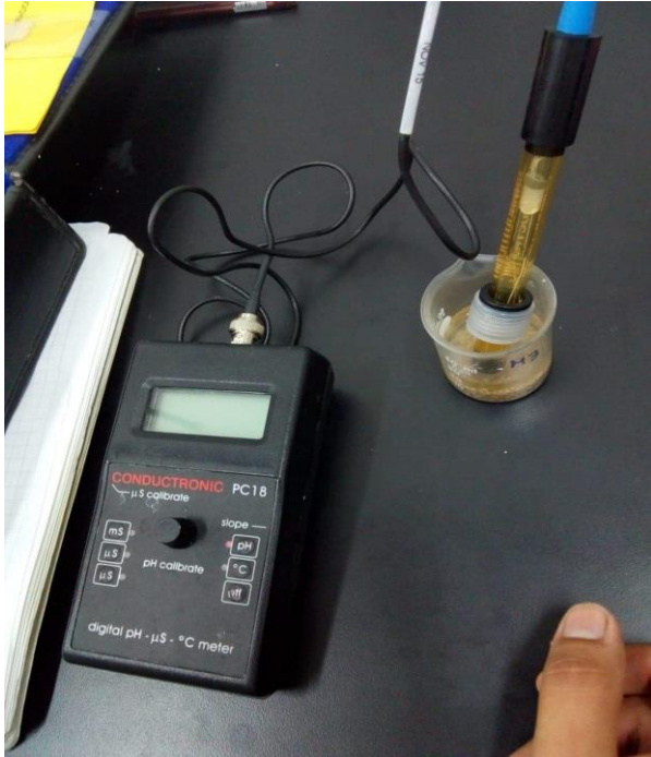
Figuras 21 (a) y (b) Foto de la metodología empleada para la medición del PH de la muestra de suelo problema.
