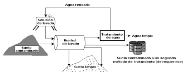
Figura 4. Lavado de suelos. Fuente: Curso de 100h de Recuperación de suelos Contaminados. Abril 2008.
