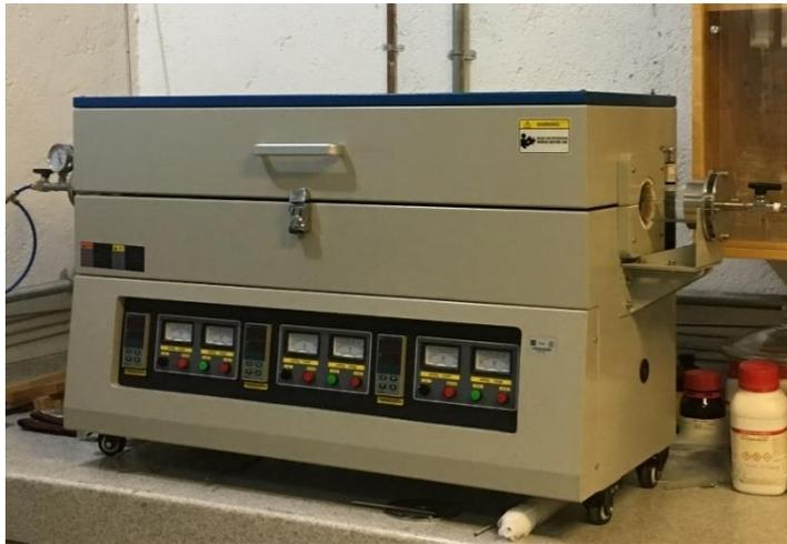
Fig. 28 Horno donde se han realizado todos los procesos térmicos realizados durante la fabricación de las celdas solares.
