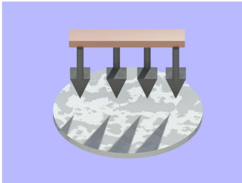
Fig. 18 Esquemático de cabezal de 4 puntas para medir resistividad.
