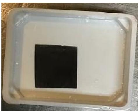
Fig. 33 Muestra sometida a texturizado mediante el proceso MACE
