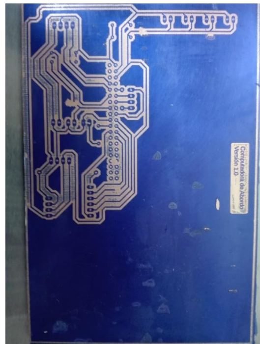
Figura 5.35 Vías afectadas al revelar la placa
