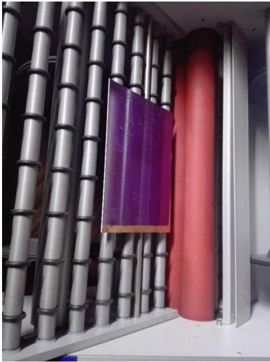
Figura 5.32 Placa de cobre con película fotosensible en la laminadora
