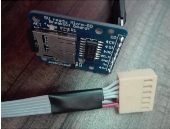
Figura 6.45 Reparación al conector de la tarjeta microSD, el cable morado es la tierra
