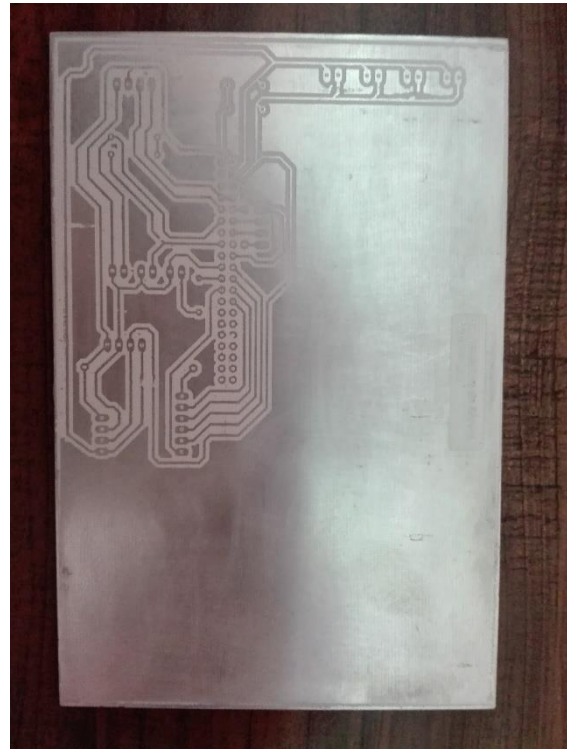
Figura 5.37 PCB después del ataque químico y recién estañada
