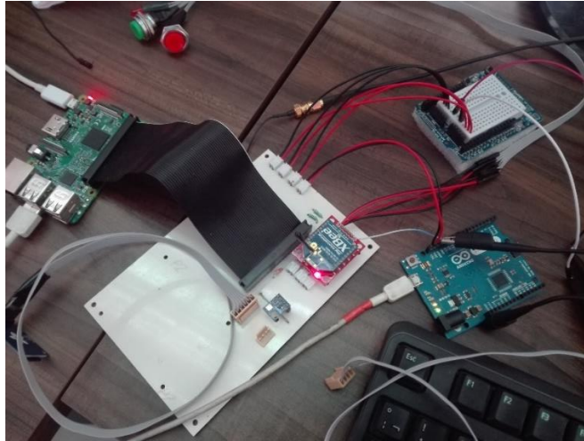
Figura 6.28 Conexión de la computadora de a bordo en la PCB
