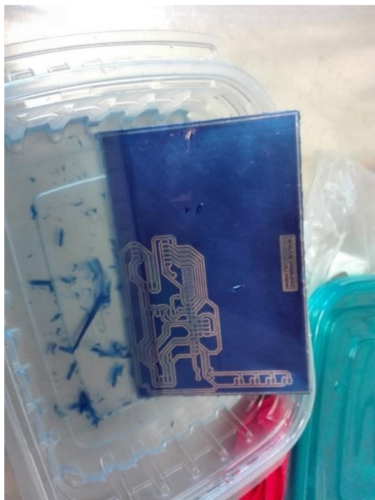
Figura 5.34 Proceso de revelado de la placa
