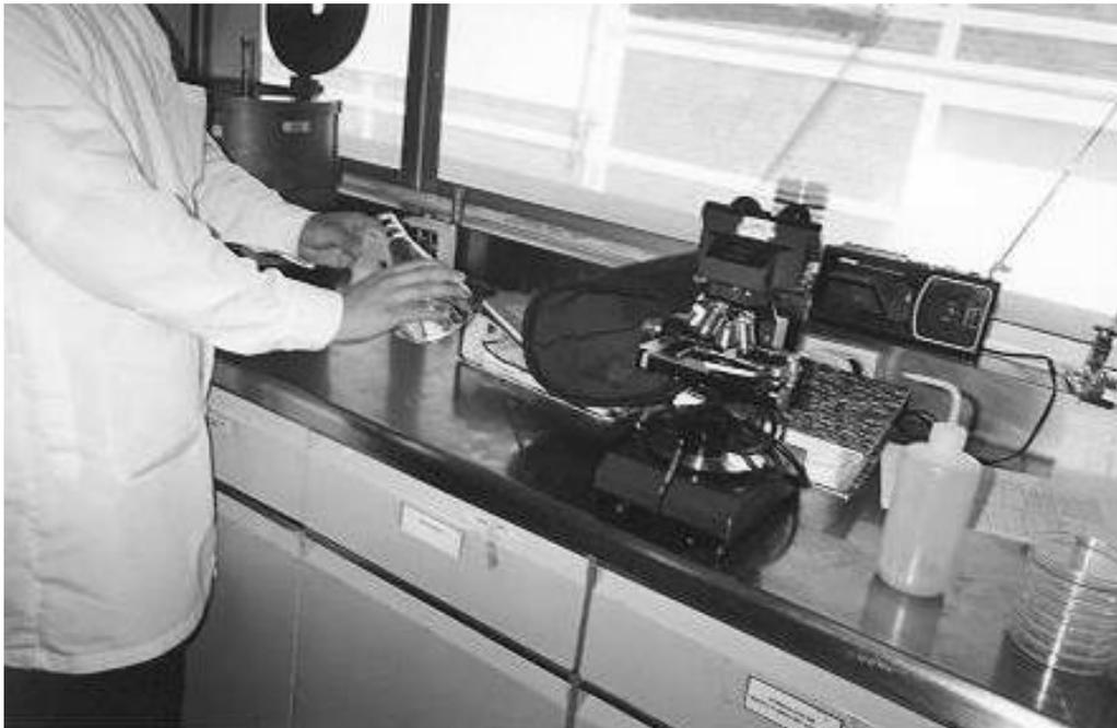
*Fig. 19. Decantar la muestra y agregar estabilizante.*
