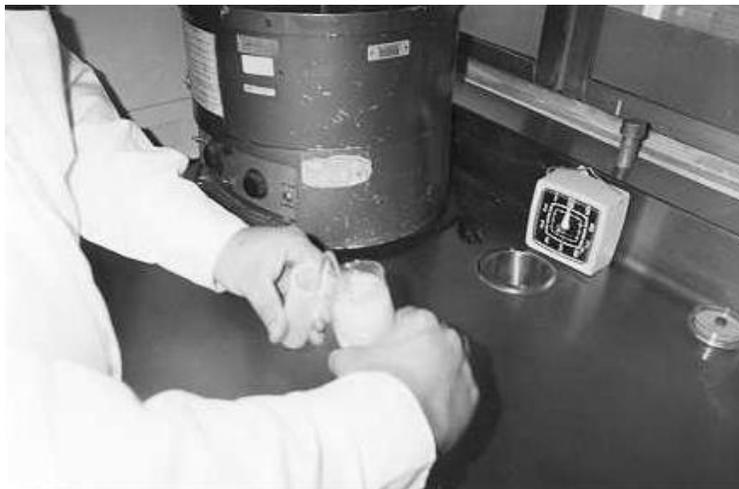
*Fig. 17. Colocar una porción de la muestra rehidratada en un tubo de centrifuga.*
