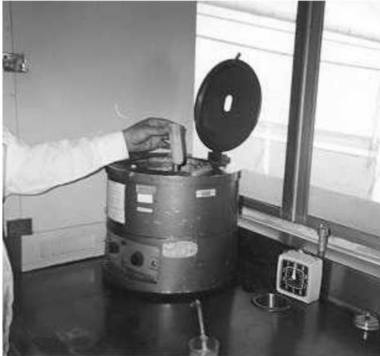
*Fig. 18. Centrifugar la muestra rehidratada.*
