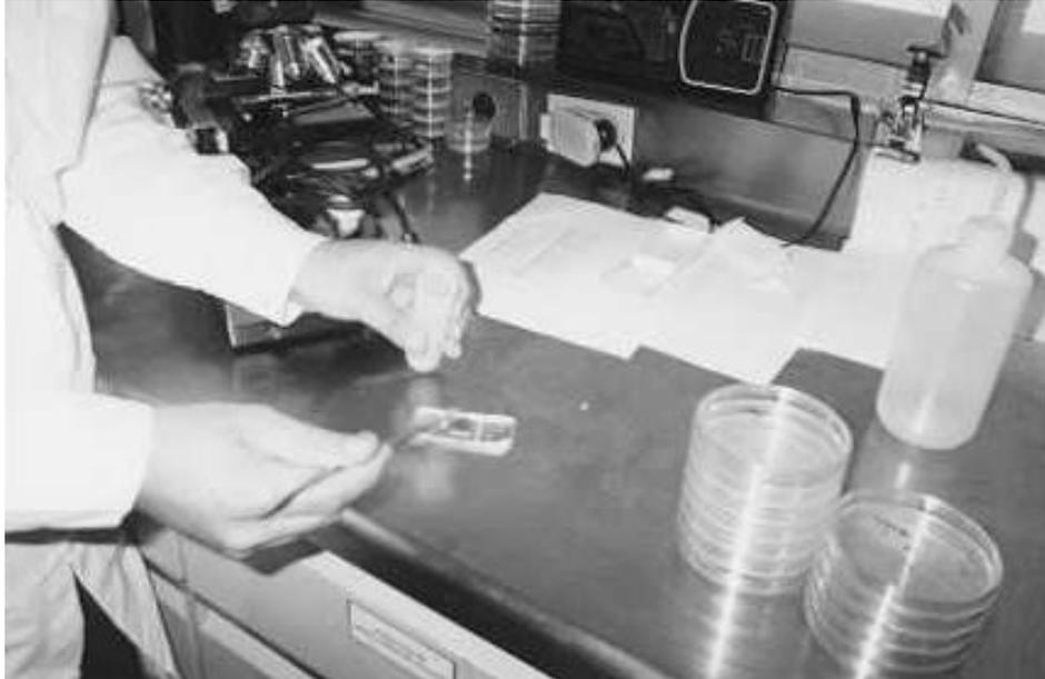
*Fig. 20. Colocar la muestra en la cámara de Howard.*
