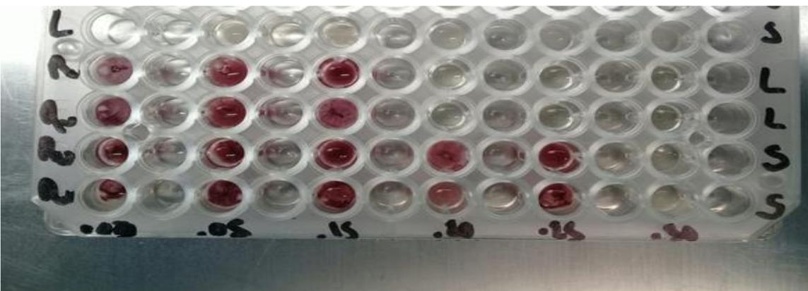
**Figura 23.** Inhibición de bacterias en un intervalo de concentración de 0.0 mM a 0.3 mM de  $[\text{Ru}_2(\text{L}^1\text{Cl}(\text{PPh}_3))_2]$  y  $[\text{Ru}_2(\text{L}^1\text{Cl}(\text{PPh}_3))_2]\{\text{Cl}^-\}$ .
