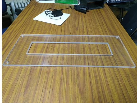
Figura 4.4: Foto del delimitador de movimiento.
