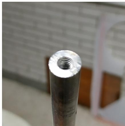
Figura 4.3: Foto de la barra mostrando una cuerda interna.
