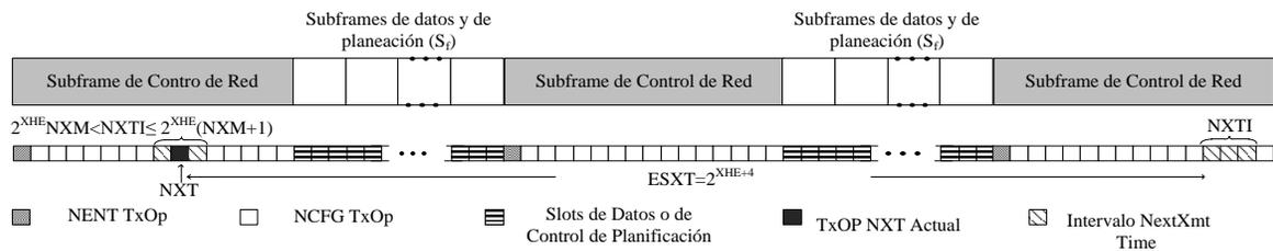
Figura 3.5 Estructura de TxOps en un multiframe mesh.
