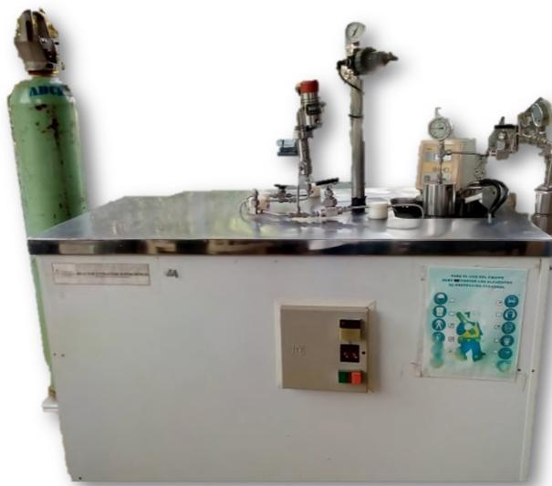
Figura 4.6: Equipo de extracción supercrítica.
