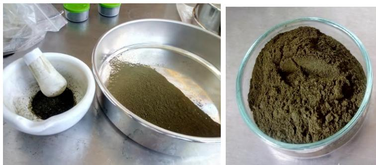
(a) Molienda y tamizado de la biomasa. (b) Biomasa obtenida después de la molienda y tamizado.
