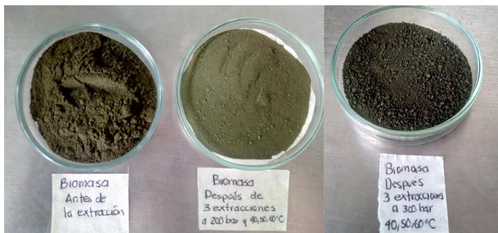
Figura 4.11: Biomasa microalgal antes y después del proceso de extracción a las condiciones de presión y temperatura propuestas.
